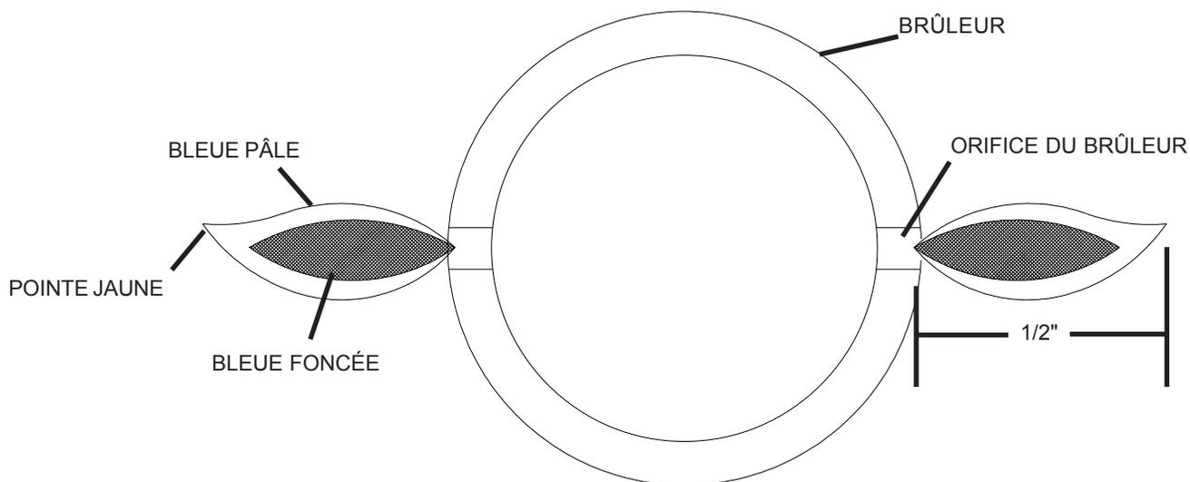
Si le brûleur ne reçoit pas assez d'air, les flammes seront jaunes pâles et produiront possiblement de la suie. Si le brûleur reçoit trop d'air, les flammes scintilleront de façon erratique et causeront possiblement des problèmes d'allumage.
